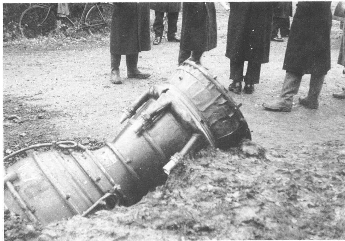
Tail end of V2 Rocket (venturi) Fairmead Bottom page 31
